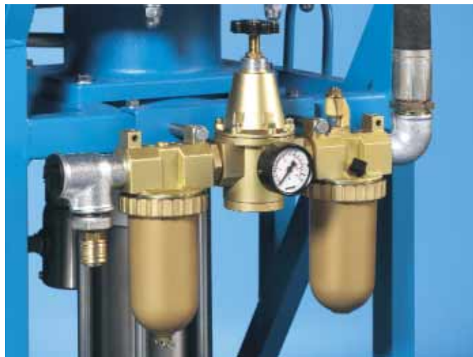
Das Vereisen des Luftmotors wird durch die serienmäßig integrierte Wartungseinheit weitgehend verhindert.
