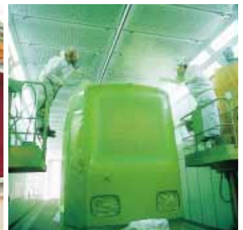
In Lackierstraßen und bei Spezialaufgaben beweisen die WIWA PROFESSIONAL Geräte als Versorgungspumpen für mehrere Spritzpistolen ihre Stärken.
